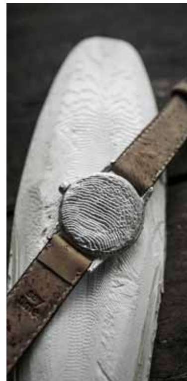
Mit Augenmaß und ganz viel Fingerspitzengefühl entstehen die Uhren aus Edelmetall, Kork und Holz. Jede Uhr, deren Gehäuse in einem Sepia-Schalen-Guss-Verfahren hergestellt wird, ist ein Unikat.
